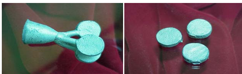
Figura 1 – Amostras de Ti c.p. após fundição odontológica, através do método de cera perdida.
